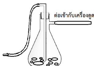
การเก็บสารปรอทที่หกโดยใช้เครื่องดูด
